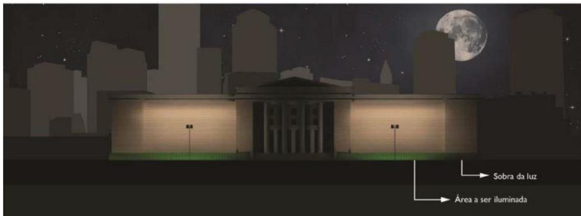
Figura - Exemplo de aplicação de projetores de Vapor Metálico 250 w, fecho médio, em postes a 15m de distância da fachada.
