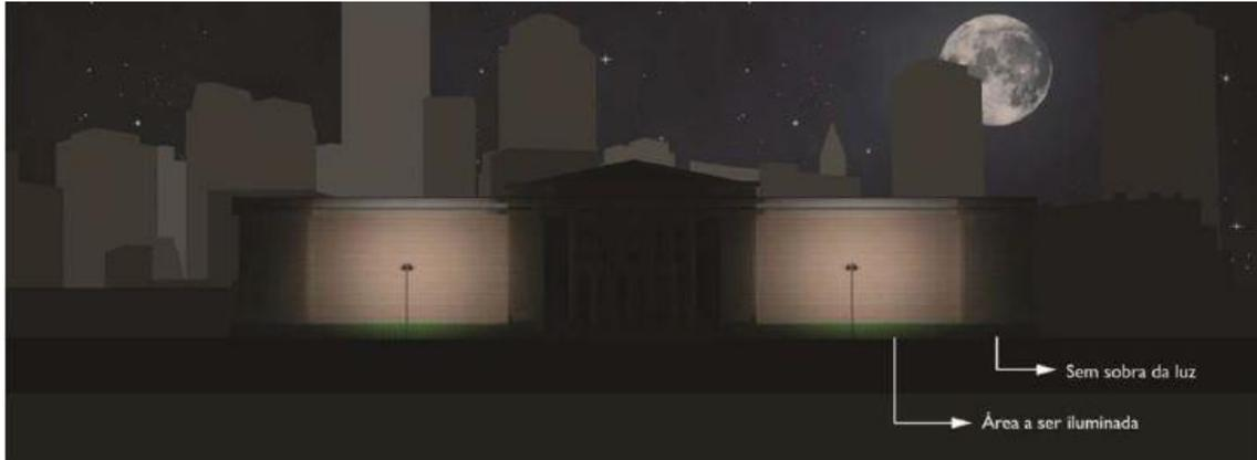
Figura - Exemplo de aplicação de projetores de LED 250 w, 40°, em postes a 15m de distância da fachada – a precisão dos feixes garante que apenas as fachadas que foram projetadas para tanto são iluminadas.
