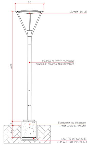
**22 DETALHE APOIO DO DE POSTE DE ILUMINAÇÃO**
