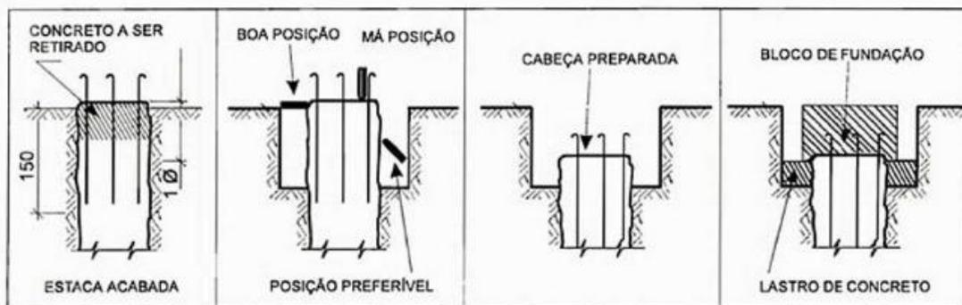
A estaca deverá ficar embutida 10cm no bloco e abaixo destes 10cm deve-se realizar lastro com concreto magro ou brita compactada.
